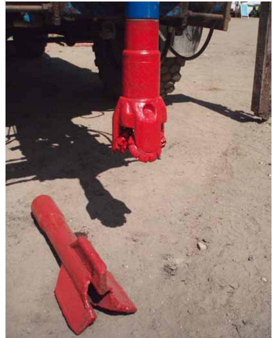
Abbildungen 10 und 11: Bohrgerät (links) und Bohrkopf (Flügelmeißel und Rollenmeißel, rechts)
